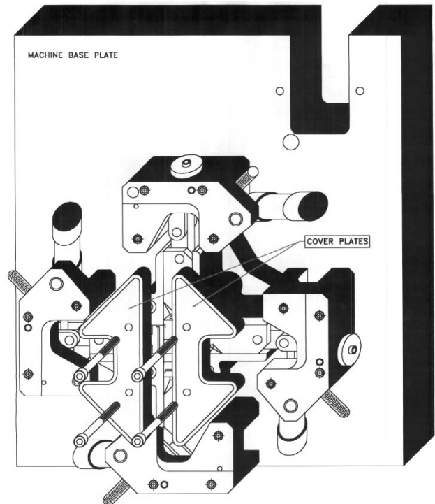
Fig. 4B-5 Miniature die casting die shown with clamps.
